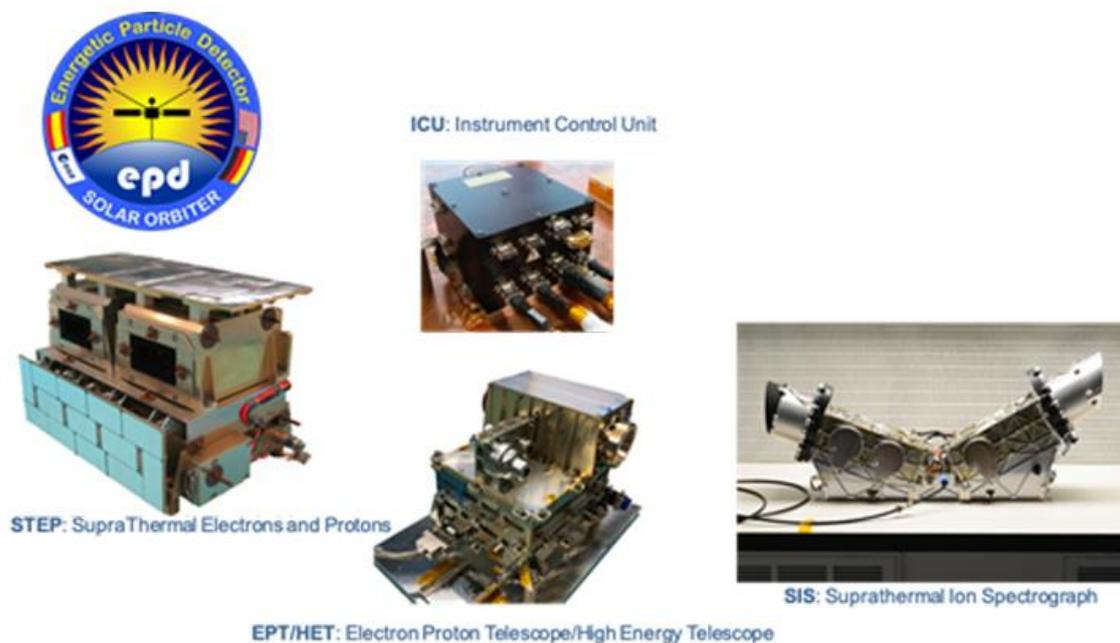
Figura 1: El instrumento EPD está compuesto por distintos telescopios de partículas: STEP, SIS, EPT/HET y la ICU
